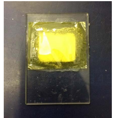
写真 1. 空気非接触測定用 XRD プレート
