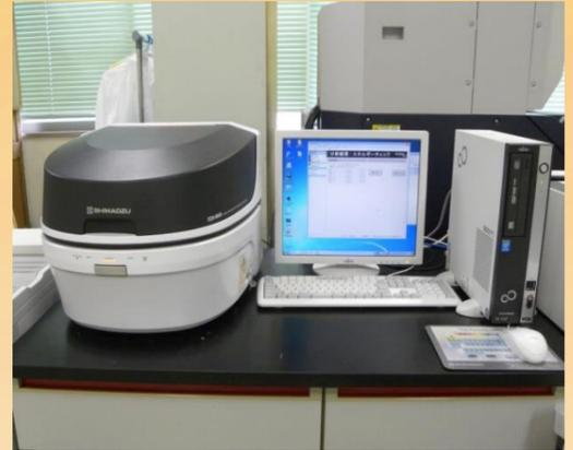
蛍光X線分析装置は、エックス線を照射した試料から発生する蛍光X線を検出することにより、試料に含まれる元素(主に金属)の定性・定量を行う装置です。
