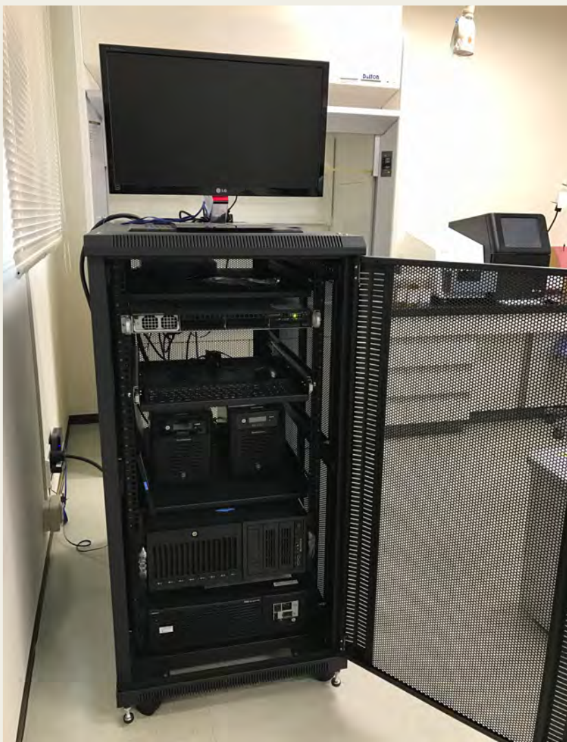
サーバー概要: Supermicro, 2 Intel Xeon CPUs (2.60-3.60 GHz, 2 CPUs 合計56スレッド 同時実行), 主記憶容量 256GB, ストレージ 4TB.
