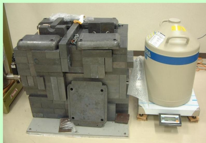
**$\alpha$ 線測定器 (左・中) と  $\gamma$ 線測定器 (右)**
